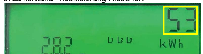
2.8.2 = Rücklieferung Niedertarif [kWh]
