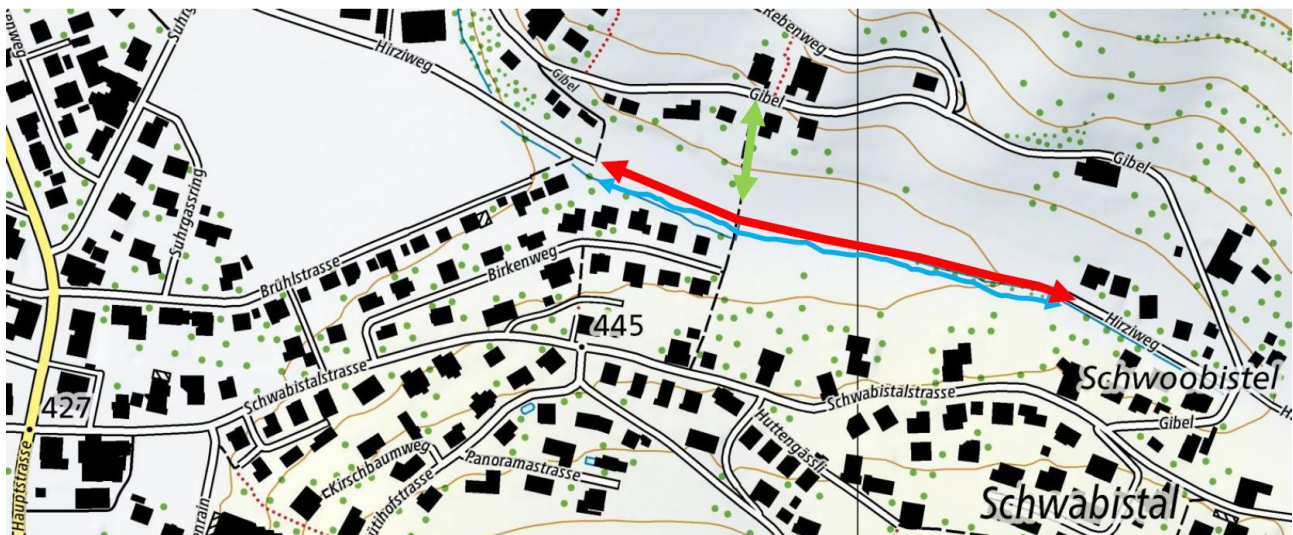
Abbildung 1: Schematische Darstellung Erschliessungsstrasse (rot), Fussweg- verbindung (grün), Schwobistelbächlein (blau) (Quelle: GeoAdmin, 23.05.2023; Planora AG)
